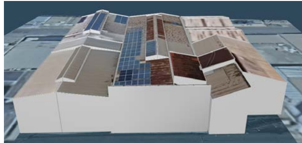
Figura 32 - Layout de Instalação dos Módulos.
