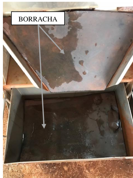
Figura 3 - Borrachas cortadas nas medidas corretas e instaladas na guia e na gaveta, utilizadas para redução do ruído no processo de quarteamento
