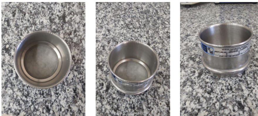
Figura 9 – Peneira granulométrica MESH 200 (75µm)
