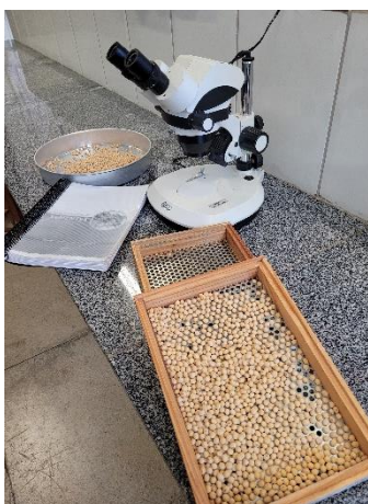
Figura 2 - Sementes de soja classificadas em peneiras 6,0 mm, 7,0 mm e descarte. Bambuí/MG, 2023.
