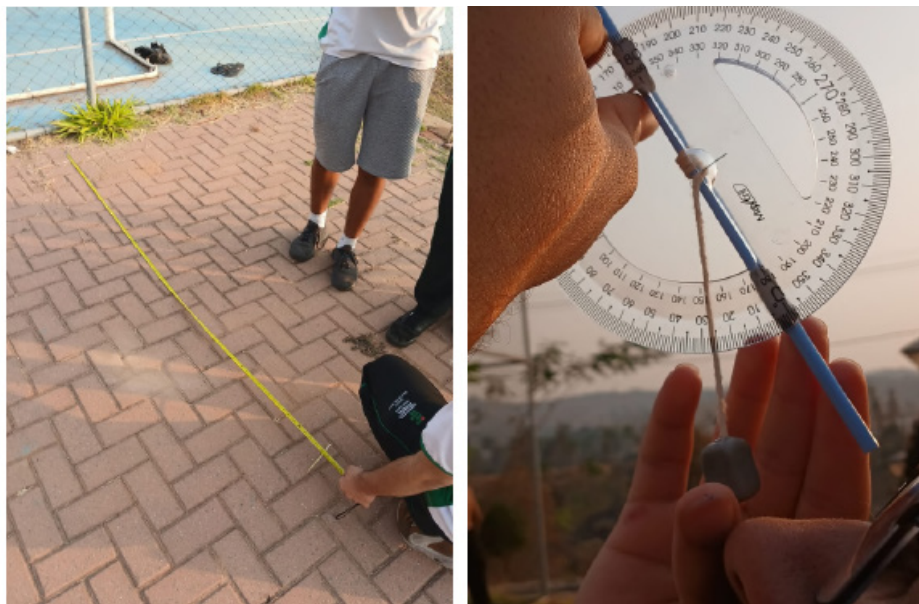
Figura 4: Foto de medição da distância horizontal (esquerda) e da medição do ângulo de elevação (direita) da quadra.
