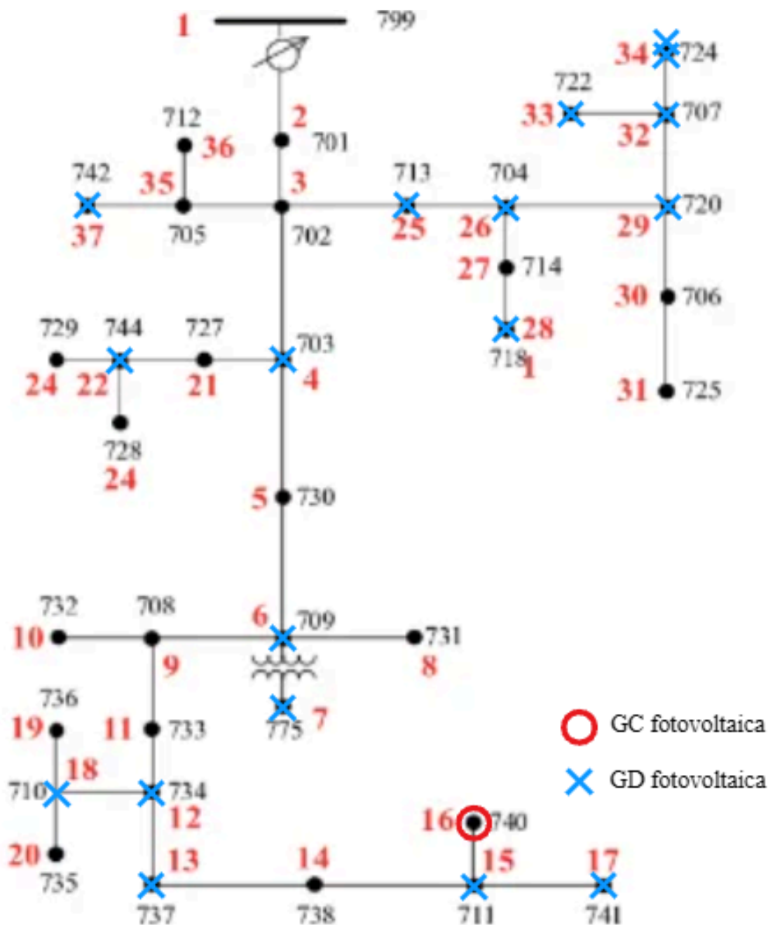
Figura 29 – Diagrama Unifilar da rede Teste IEEE 37 barras.
