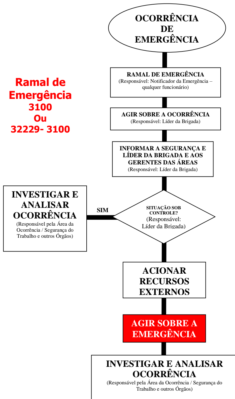
Figura 1- Fluxo Geral de Acionamento para Emergências de Saúde, Segurança, Operacional e Meio Ambiente
