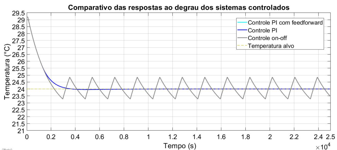
Figura 6.1 – Comparativo das respostas ao degrau dos sistemas com as três estratégias de controle, sem perturbação.
