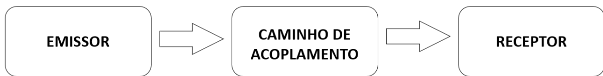
Figura 32 – Interação eletromagnética entre equipamentos.
