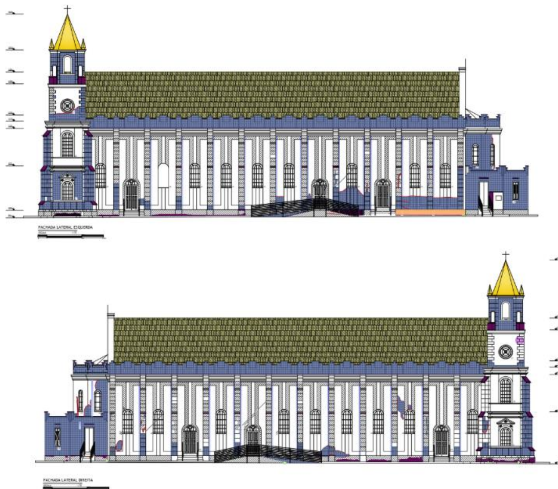
Figura 39: Mapeamento de danos realizado na etapa projetual de análises e diagnóstico das manifestações patológicas
