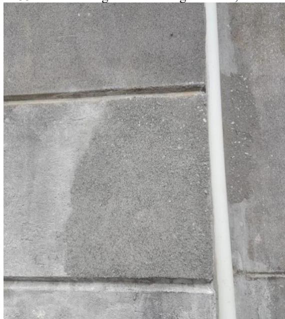
Figura 33: Teste em larga escala da argamassa 2, tom médio.
