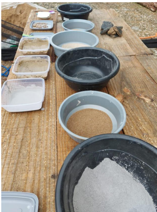
Figura 25: Insumos selecionados para início dos testes de argamassa.
