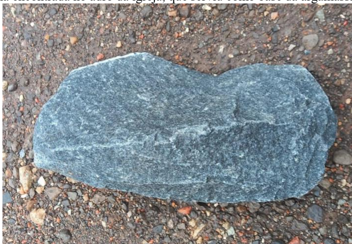
Figura 28: Rocha encontrada no adro da igreja, que serviu como base da argamassa do pó de pedra.
