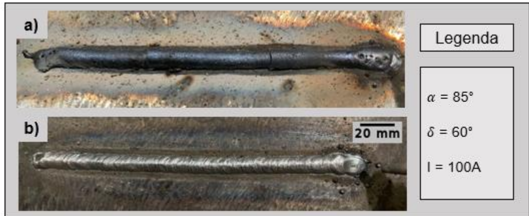
Figura 19 – a) Cordão de solda 3 com escória; b) Cordão de solda 3 sem escória.
