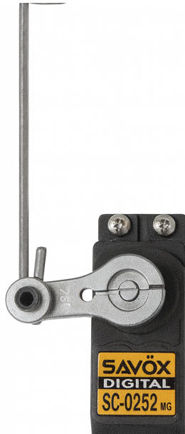
Figura 9 – Servomecanismo digital SC-0252MG com ligação mecânica ao comando de voo.
