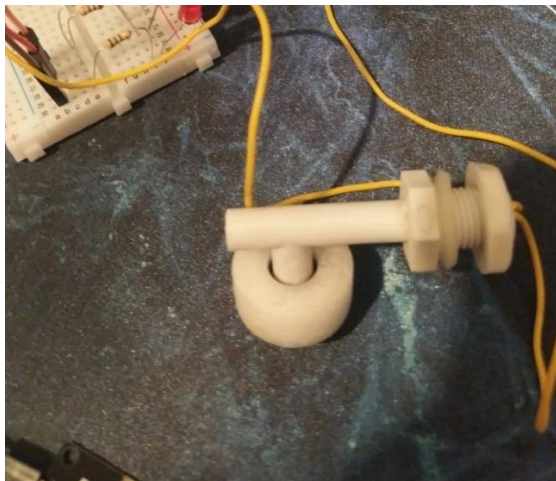
Figura 13: Ligação Sensor de Nível de Água
