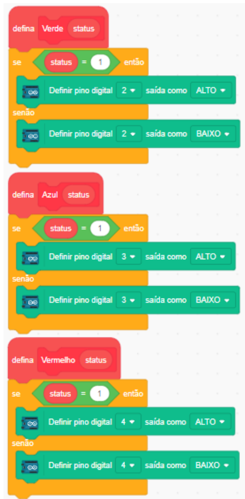
Figura 30 – Funções base para acionamento dos LEDs.
