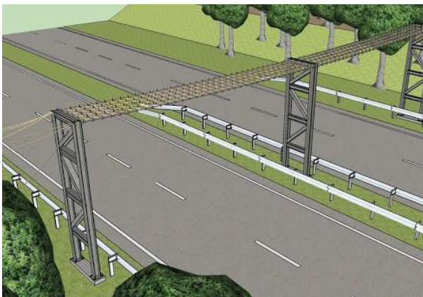
Figura 11. Esquema de passagem de fauna suspensa. Fonte: O Eco (2016).
