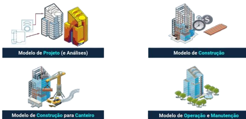
Figura 2 – Diferentes modelos BIM para diferentes usos
