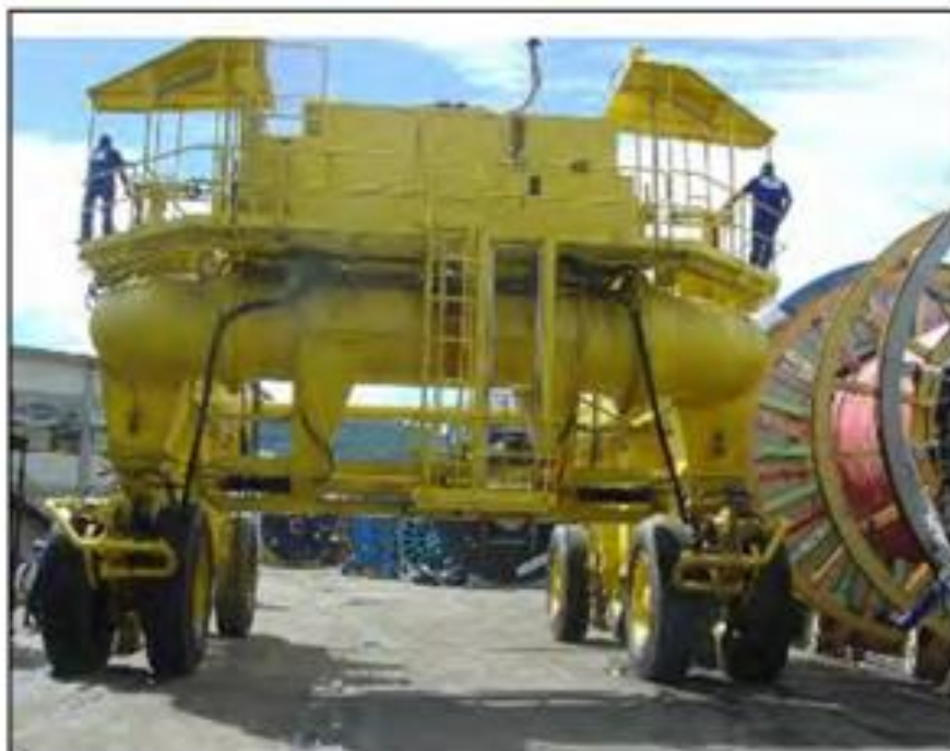
Figura 03 - Veículo transportador de bobinas (Jumbo)
