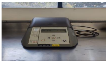
Figura 24 – Analisador de espectro, Spectroquant TR 420, utilizado para análise de DQO
