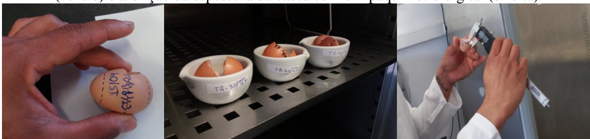
Figura 18 – Separação da casca em três diferentes regiões (esquerda); cascas de ovos na estufa (centro) e aferição da espessura da casca com um paquímetro digital (direita).
