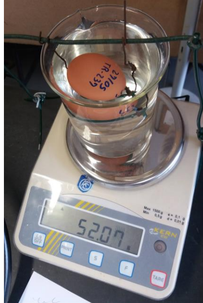
Figura 14 – Estrutura montada para pesagem do ovo na água.
