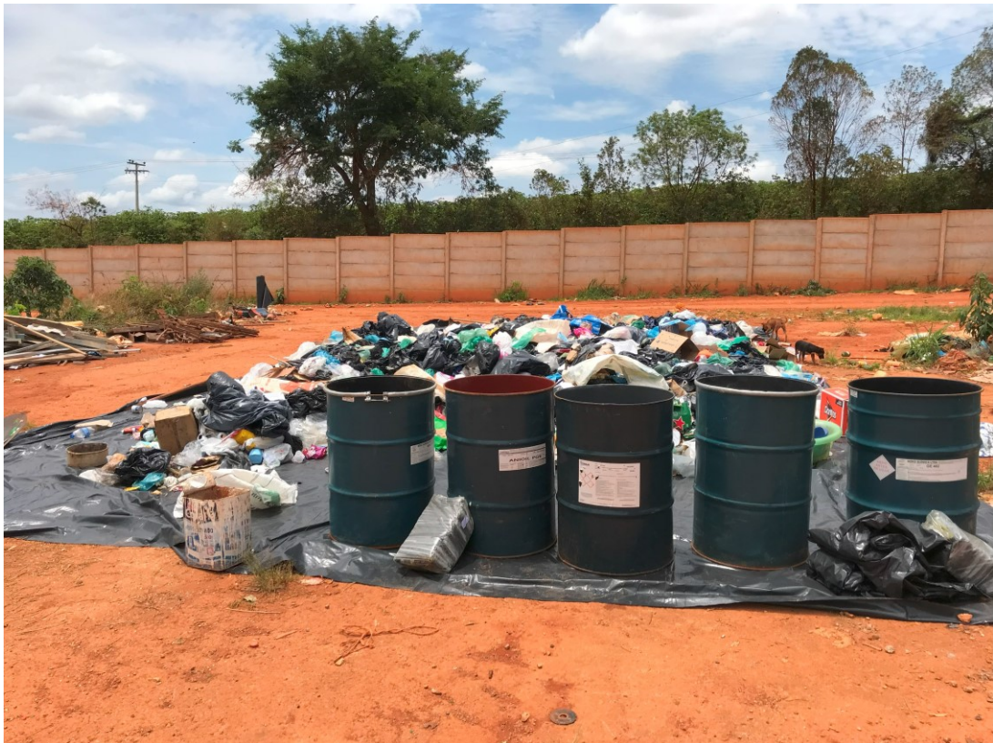
Figura 10 - Acondicionamento das amostras dos RSU para triagem
