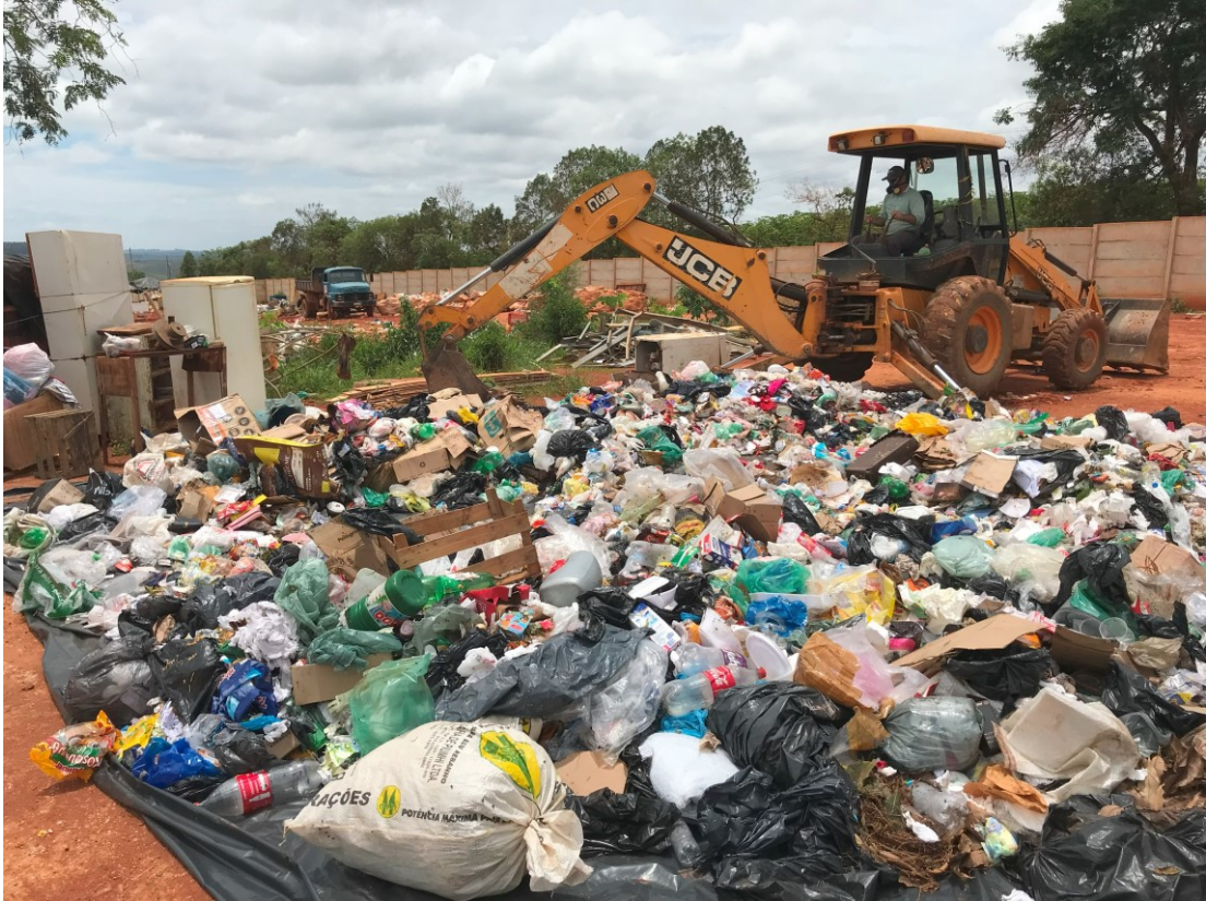
Figura 9 - Quarteamento realizado com o auxílio de uma retroescavadeira
