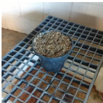
Figura 5: Drenagem após saturação para determinação de massa úmida, CRec e EA.
