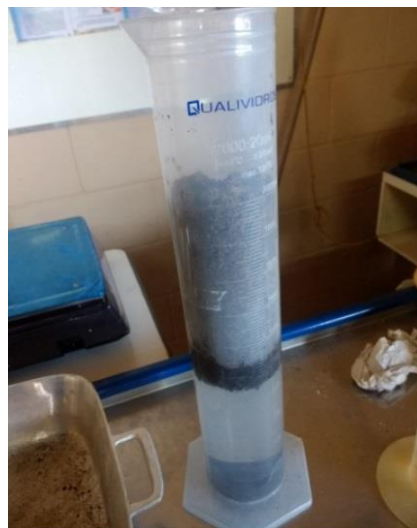
Figura 4: Ensaio para determinação de Volume de Poros e Sólidos.
