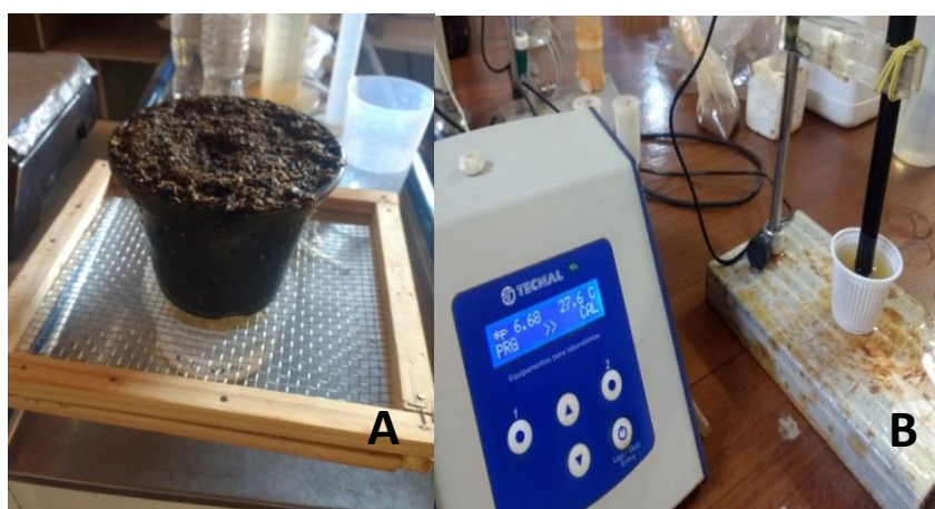
Figura 6: Coleta do “lixiviado” – A; Análise no Laboratório de Solos IFMG Bambuí – B.
