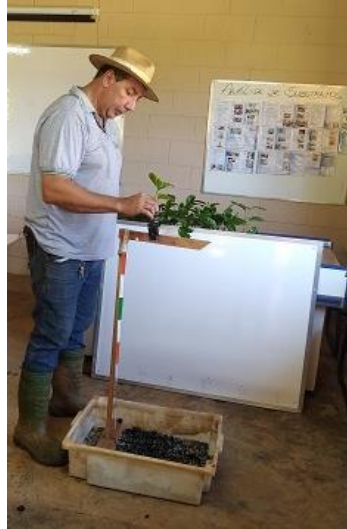
Figura 13: Avaliação de agregação do substrato utilizando gabarito para altura de um metro.
