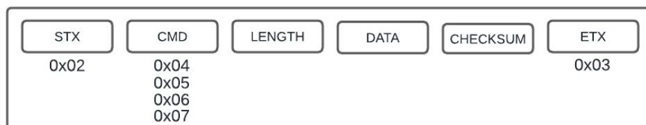
Figura 31 – Protocolo STX/ETX implementado.
