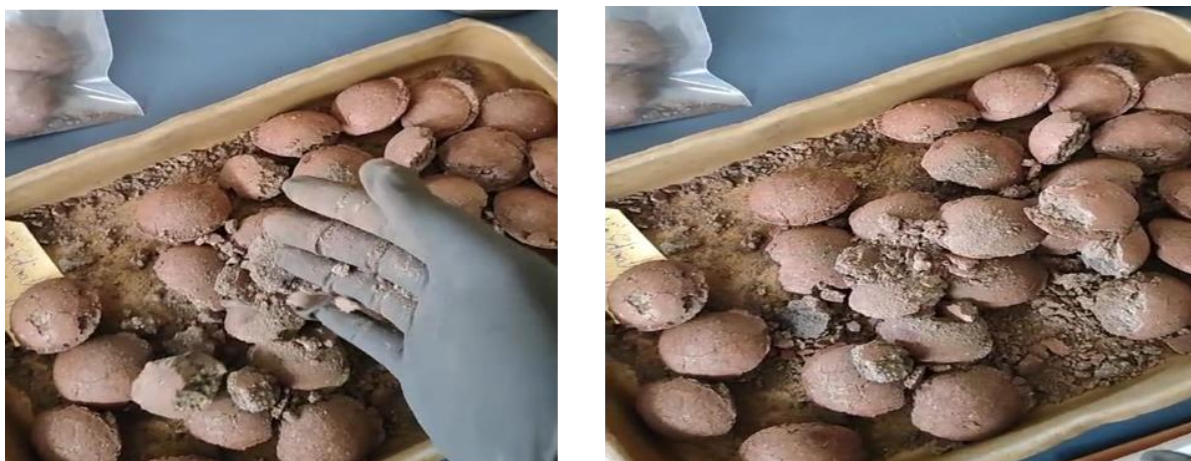
Figura 19: Briquetes se desintegrando com facilidade
