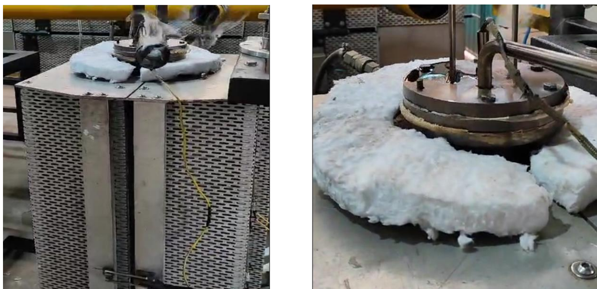
Figura 17: Equipamento em funcionamento para teste de RDI
