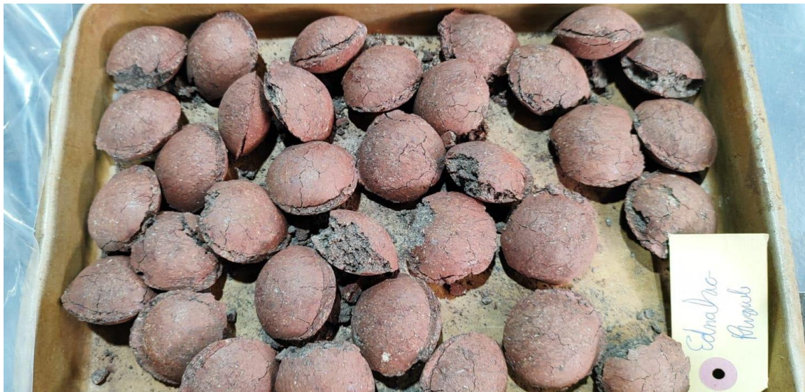
Figura 18: Briquetes após endurecimento a 500°C
