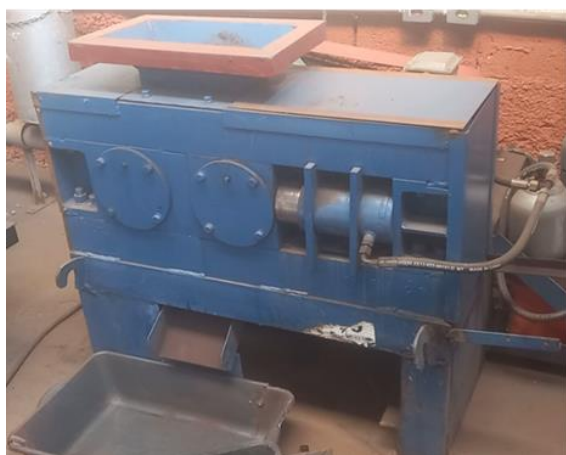
Figura 9: Briquetadeira de rolos
