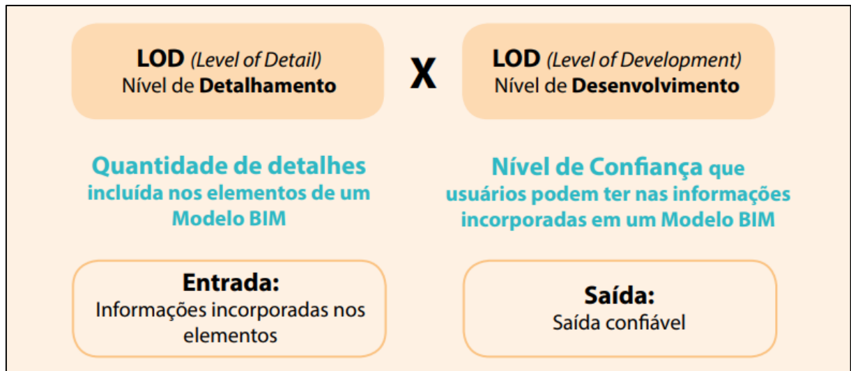
Figura 13 – Comparação dos conceitos de LOD diferenciação entre Nível de Detalhamento e Nível de Desenvolvimento.
