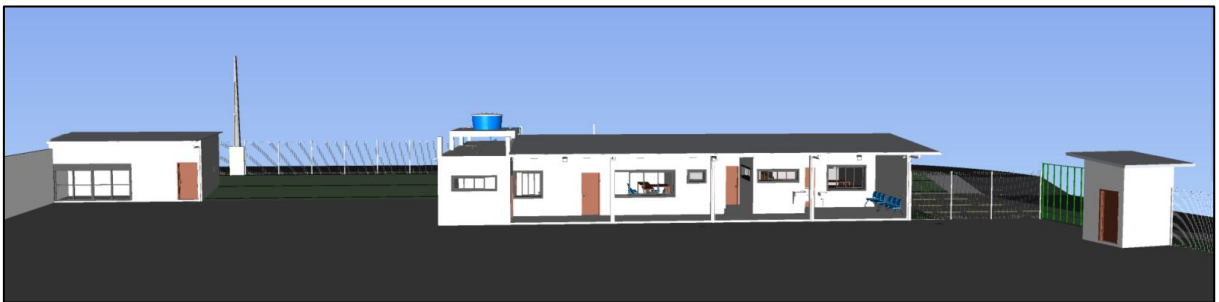
Figura 25 – Modelo compatibilizado no Navisworks , compatibilização completa e com sobreposição correta de todas as disciplinas por meio do ponto 0,0,0.
