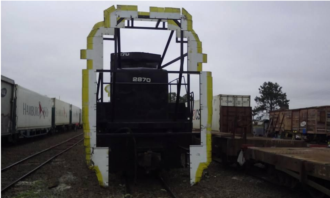
Figura 4 - Teste de gabarito em locomotiva operacional da frota
