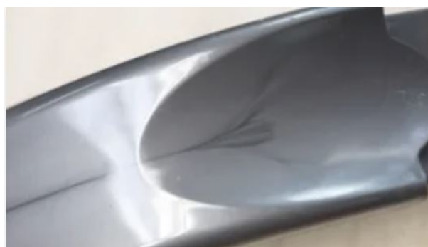
Figura 19 – Peça com marca de fluxo.
