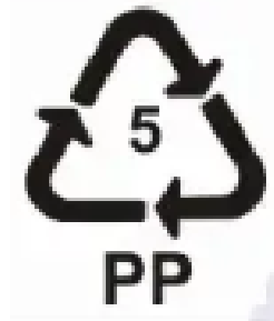
Figura 8 – Simbologia de identificação do polipropileno.
