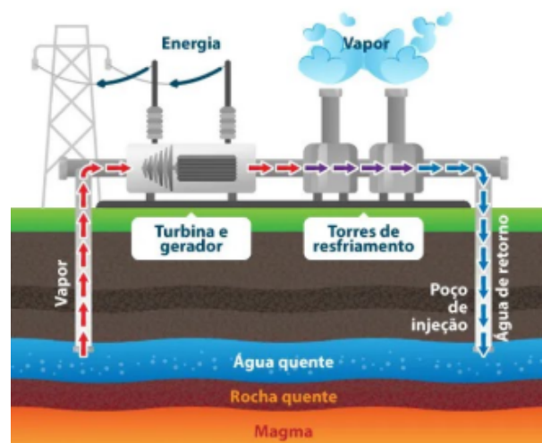
Figura 2.2 – Sistema Geotérmico Aberto
