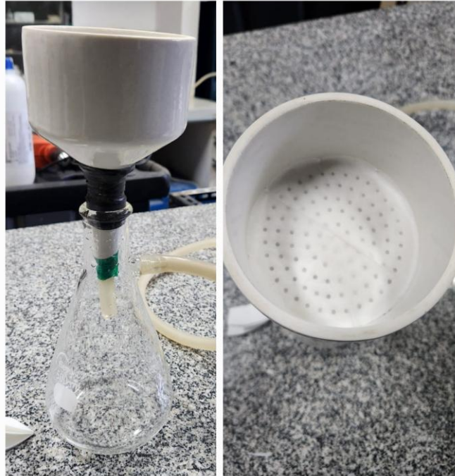
Figura 36 - Registro do funil Büchner acoplado ao sistema de sucção.
