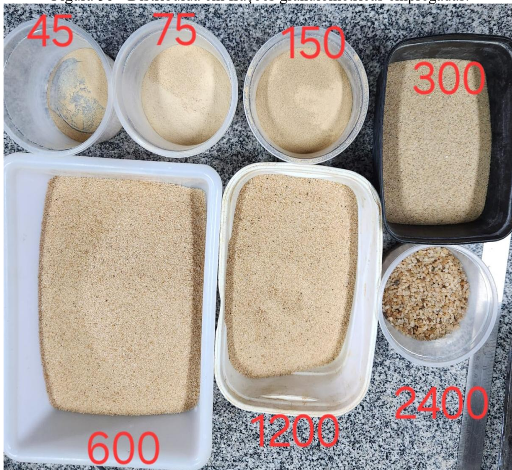
Figura 50 - Distribuída em frações granulométricas empregadas.
