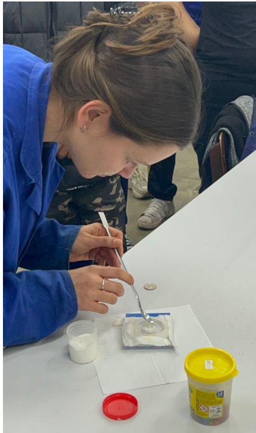
Figura 26 - Distribuição uniforme da amostra AH 45 \mu m no porta amostras.
