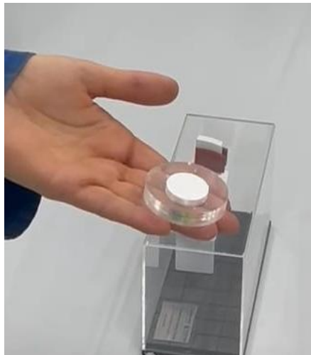
Figura 27 - Porta amostras com a amostra AH 45 \mu m.
