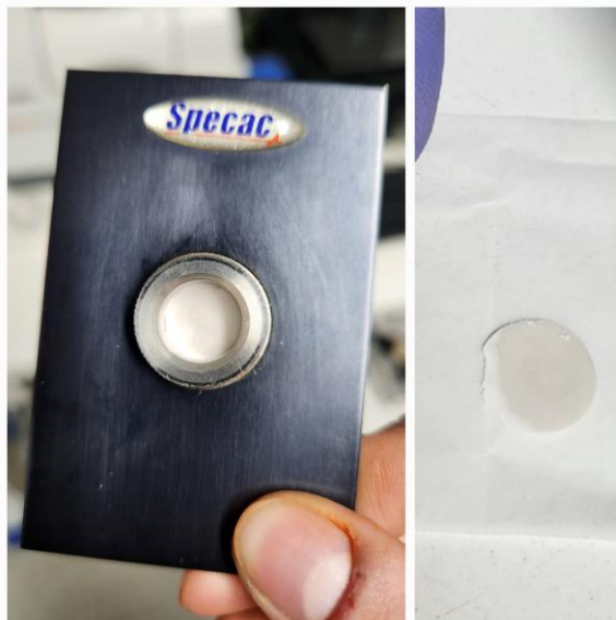
Figura 24 - Porta amostras com a pastilha e a pastilha.
