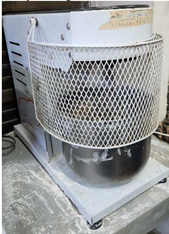
Figura 51 - Preparo da argamassa com misturador mecânico.
