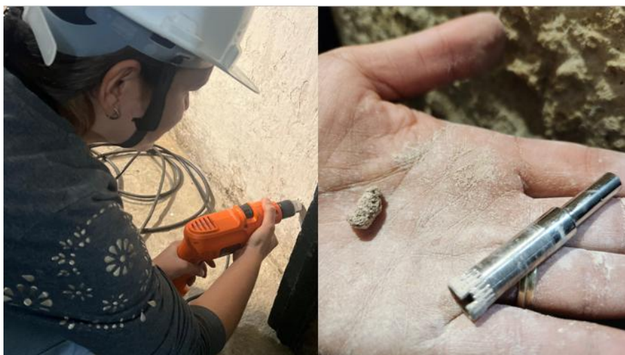
Figura 6 - Remoção da amostra A2 com o auxílio de uma serra copo de 10 mm de diâmetro, acoplada a uma furadeira elétrica.
