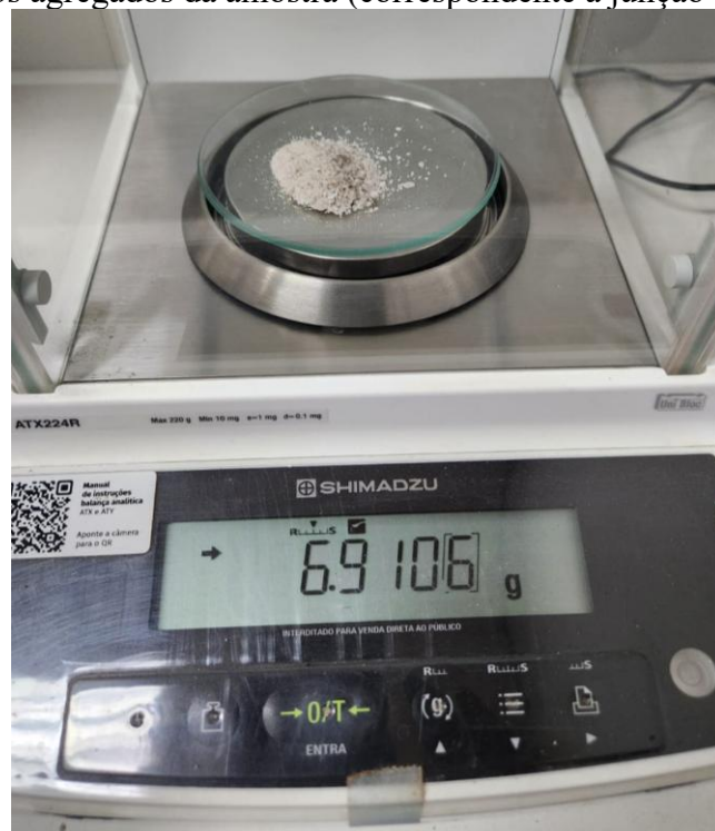
Figura 42 - Peso dos agregados da amostra (correspondente a junção de AFQ 1 e AFQ 3).
