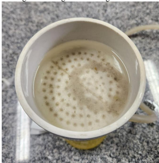
Figura 37 - Registro da filtração a vácuo.
