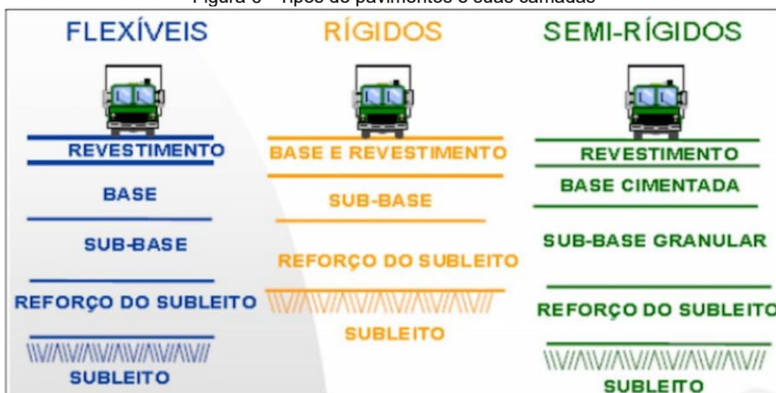
Figura 6 - Tipos de pavimentos e suas camadas
