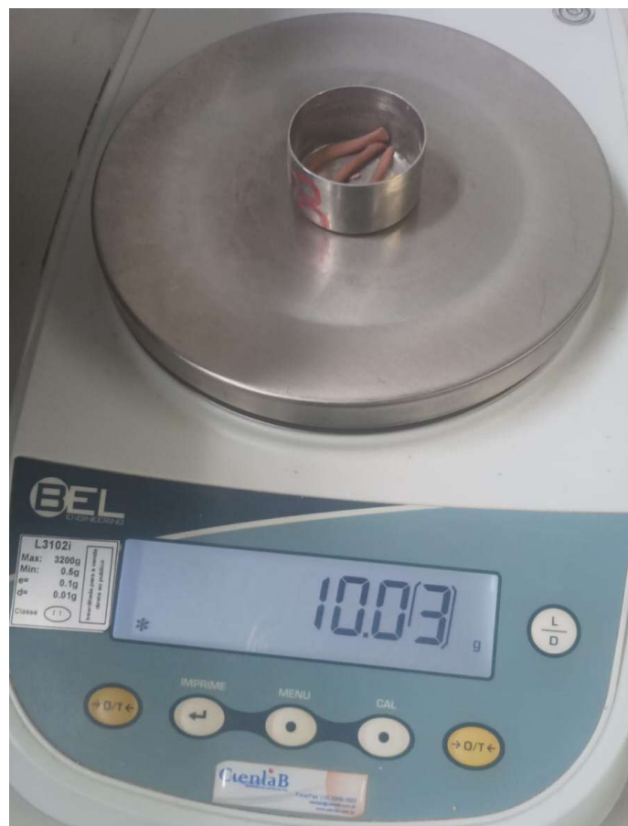
Figura 50 – Ensaio de limite de plasticidade – Cápsula+solo úmido – Amostra 1.
