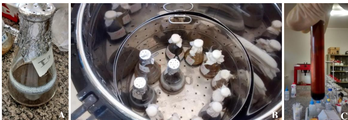
Figura 15 – Etapas da Extração termoquímica: A – Erlenmeyer com massa visceral pré-tratada; B – Erlenmeyer em autoclave; C – Óleo de peixe pós centrifugação
