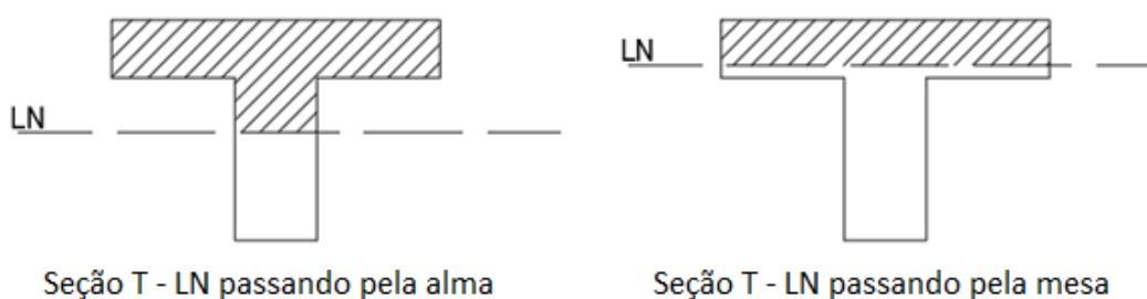
Figura 6 - Seção de viga alternando em T ou retangular de acordo com a LN.
