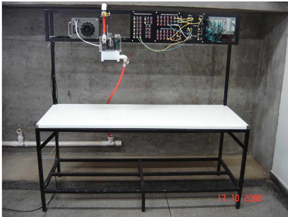
Figura 6 – Bancada didática de controle de nível.
