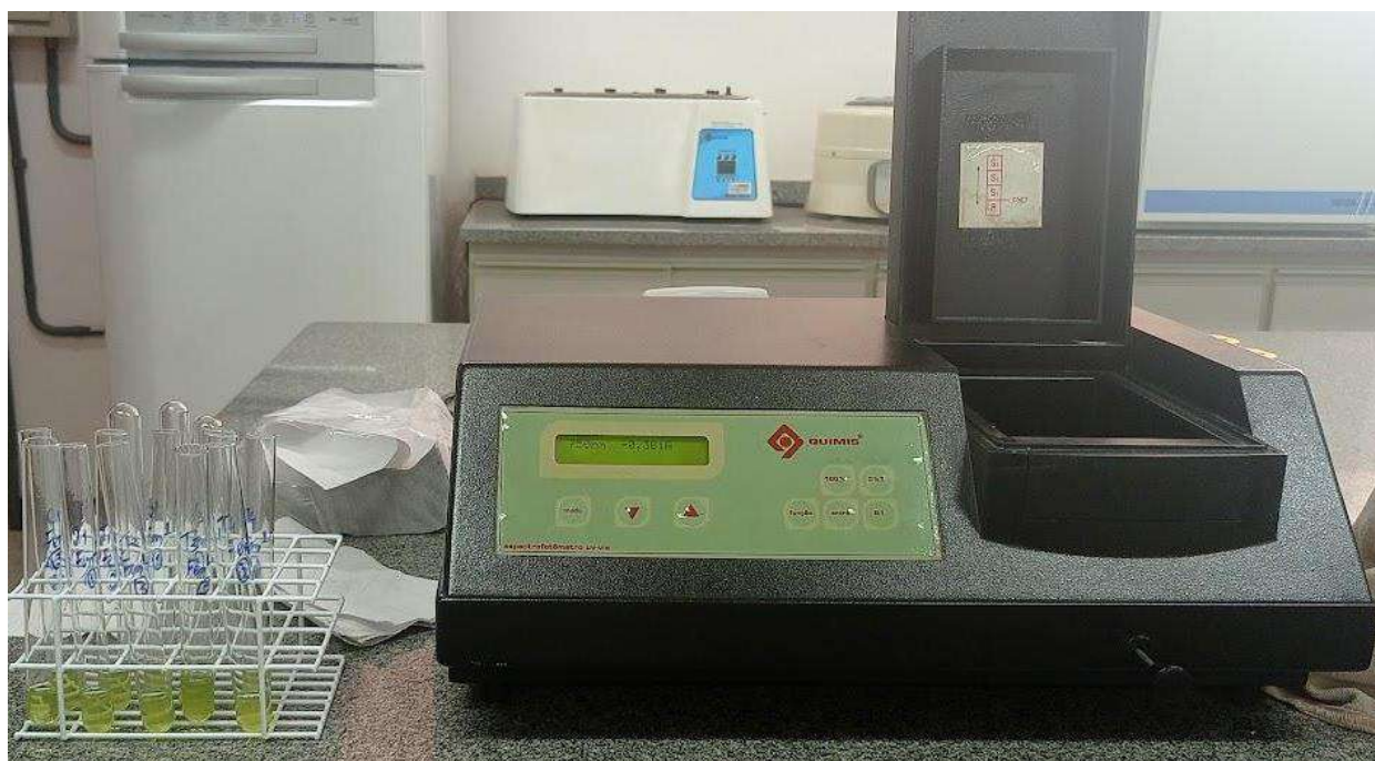
Figura 8. Amostras levadas para leitura em espectrofotômetro.
