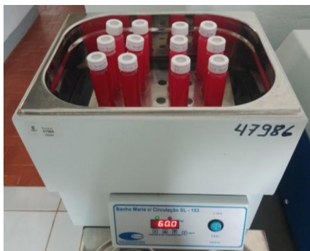
Figura 7 - Análise de CO 2 - liberação do CO 2 por meio de aquecimento em banho-maria
