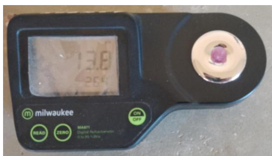
Figura 8 - Refratômetro de bancada utilizado para análise de sólidos solúveis totais
