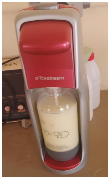
Figura 5 - Equipamento utilizado para carbonatação do soro
