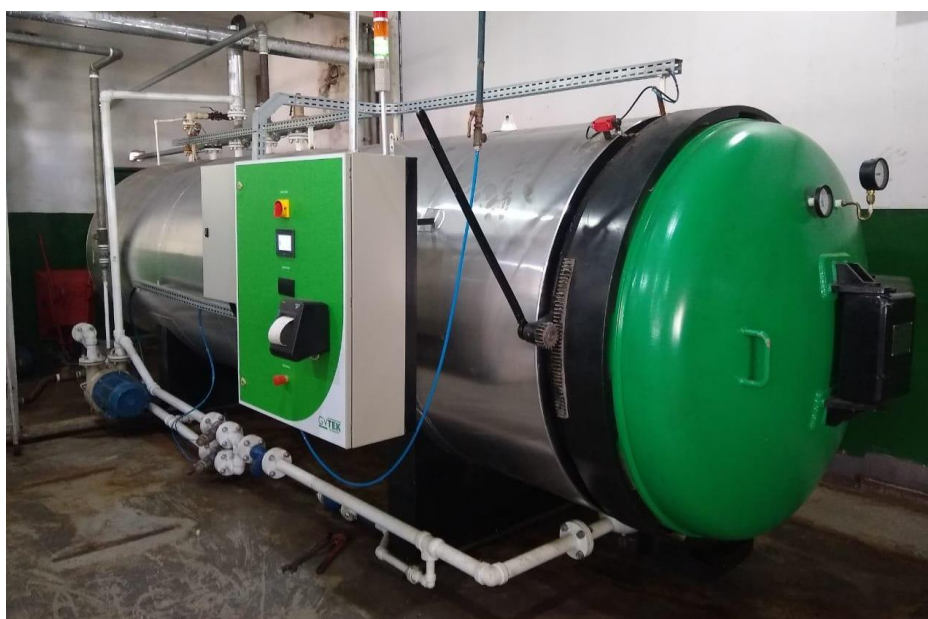
FIGURA 13 - AUTOCLAVE DA EMPRESA VIASOLO ENGENHARIA AMBIENTAL S/A
