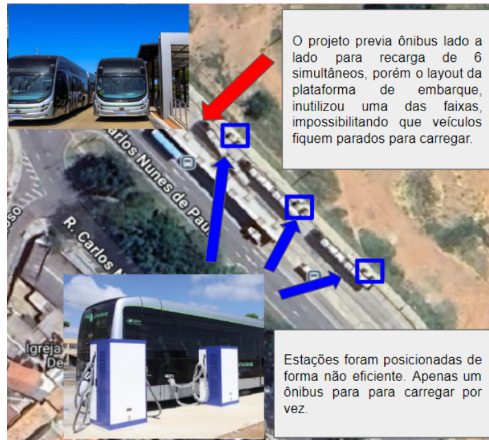
Figura 40 – Problemas de layout no eletroterminal de São José dos Campos
