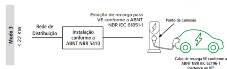
Figura 6 - Modo 3 de carregamento para VEs conforme a NBR IEC 61851-1.
