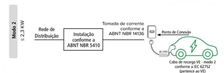
Figura 5 - Modo 2 de carregamento para VEs conforme a NBR IEC 61851-1.
