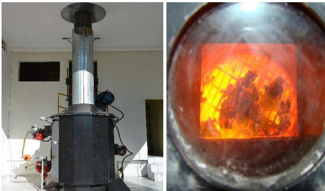
Figura -Incinerador de carcaças de suínos e aves e resíduos de alto risco sanitário (A). Carcaça durante processo de incineração com temperatura superior a 800°C (B). Laboratório TEC-DAM, Embrapa Suínos e Aves, 2017.
