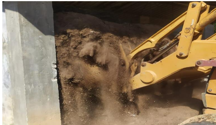
Figura 14 – Retirada do material após cinco meses das baias de compostagem em São Sebastião do Oeste, MG
