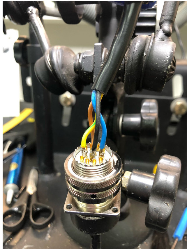
Figura 2 – Etapa 1 - Soldagem das vias.
