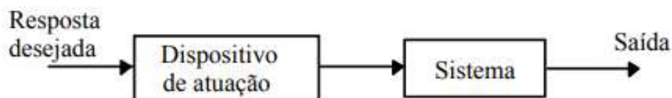
Figura 8 – Sistema de controle em malha aberta.
