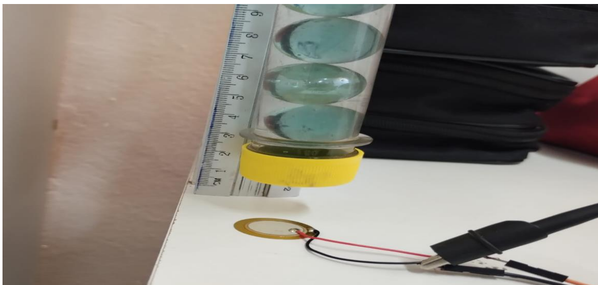
Figura 28 - Teste de queda da massa na altura de 0,01m em superfície rígida.
