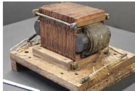
(b) Primeiro transformador.
