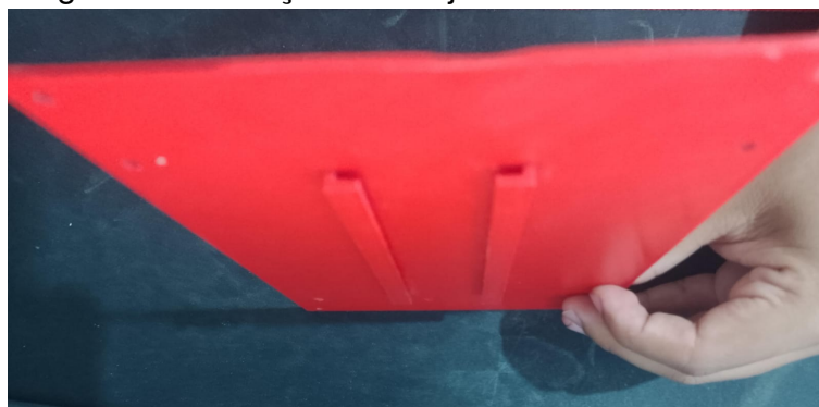
Figura 10 – Fixação do conjunto final em trilho DIN.
