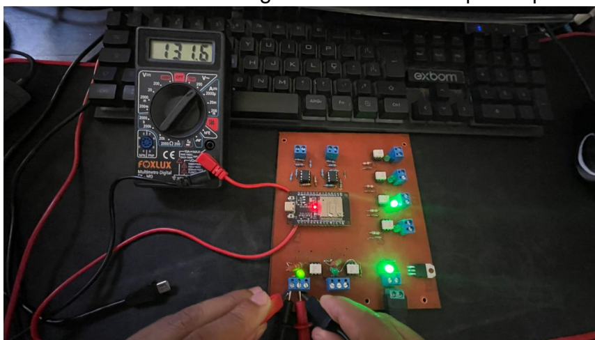
Figura 15 – Teste da entrada digital em 220 V com optoacoplador 4N25.
