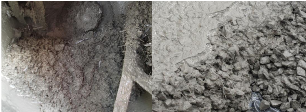
Figura 14 e 15 - Concreto reforçado com fibras plásticas.
