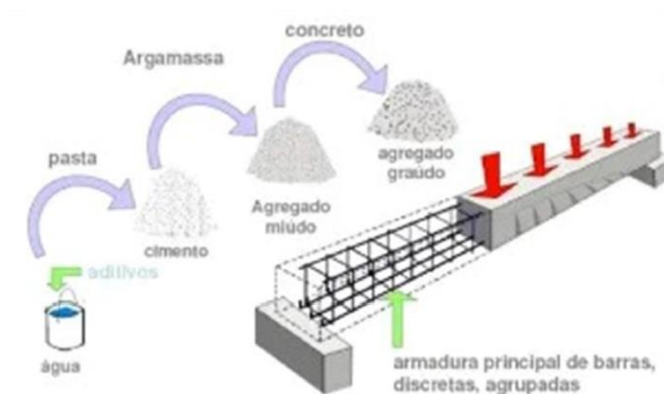
Figura 7 - Produção do Concreto Convencional.
