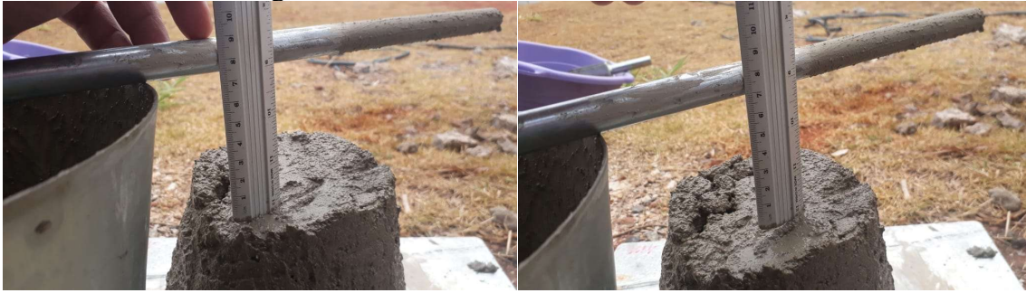
Imagem 5- Ensaio de abatimento do concreto referência
