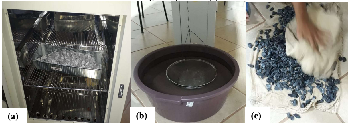
Imagem 3 - Obtenção da constância de massa em estufa (a); Submersão da amostra (b); Secagem superficial (c)
