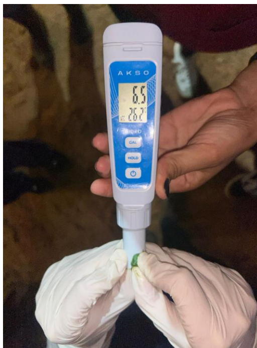
Figura 2. Mensuração do pH salivar utilizando pHmetro digital portátil (AK90 New Hidro®, Akso).
