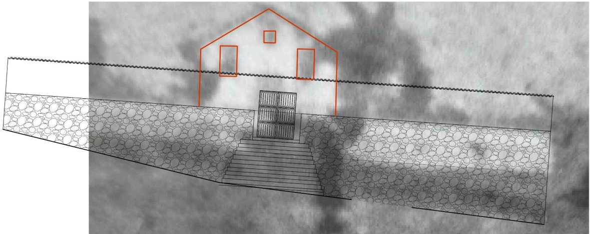
Figura 23: Método de sobreposição do levantamento e imagem.
