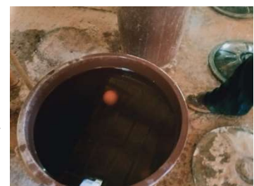
Aferição da gravidade específica com o ovo mergulhado em solução salina
