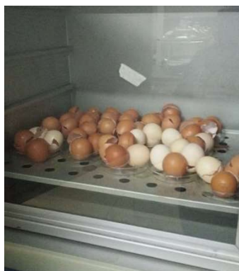
Cascas lavadas e dispostas em placas para secagem em estufa
