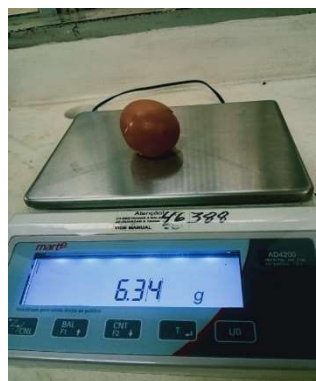
Pesagem da casca seca em estufa em balança analítica
