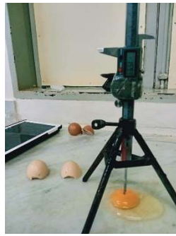
Altura da gema com auxílio de paquímetro eletrônico
