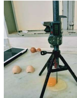
Altura do albúmen com auxílio de paquímetro eletrônico
