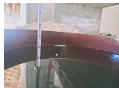
Densímetro de petróleo em solução salina calibrada.
