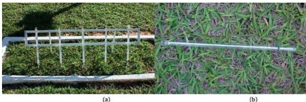
Figura 9 – Termômetros usados para medir a temperatura do solo: a) Conjunto de geotermômetros; b) Termômetro de relva.
