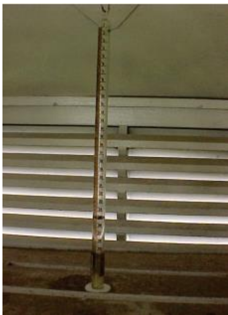
Figura 11 – Evaporímetro de Piche Fonte: Vianello (2011).
