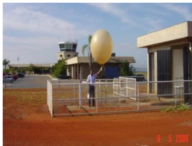
Figura 5 – Balão com gás hélio acoplado à radiossonda
